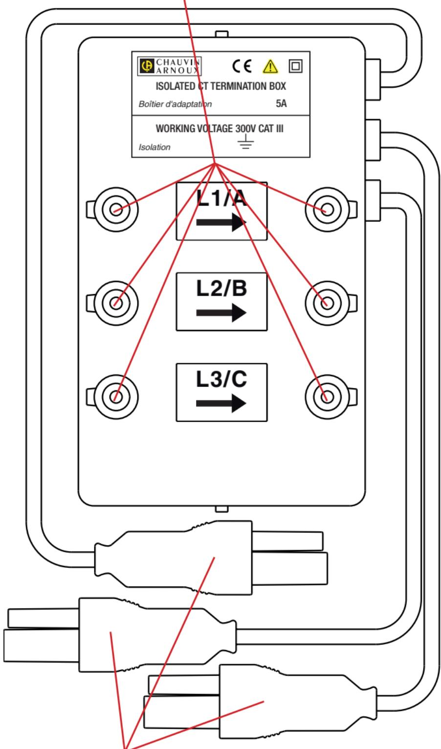
Prese per connessione all'analizzatore di potenza e d'energia.
