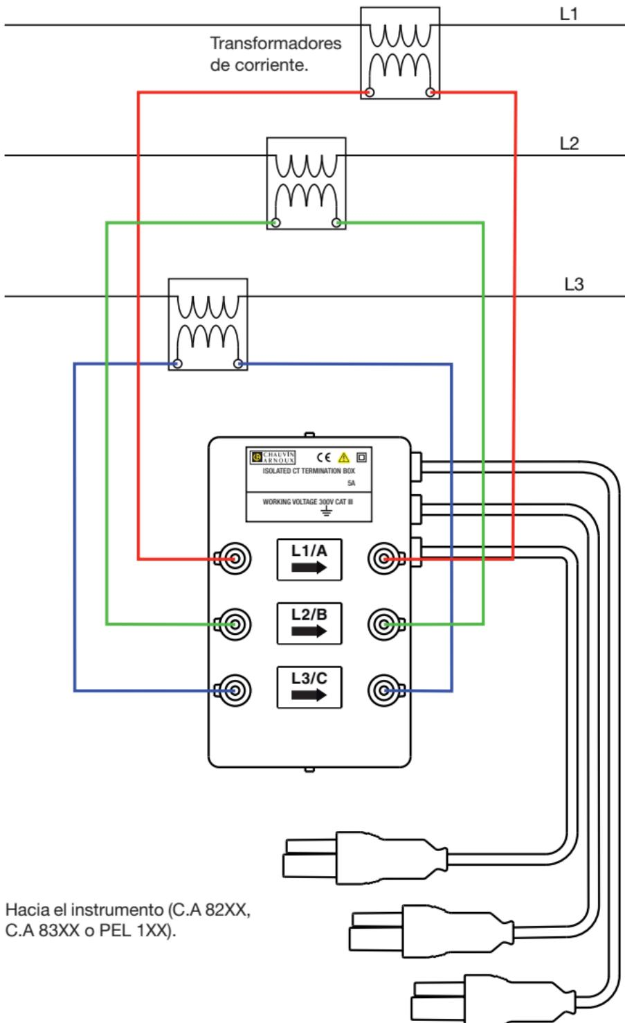
Conecte las tomas a los bornes de corriente del analizador. El analizador reconoce automáticamente el adaptador trifásico 5 A.
