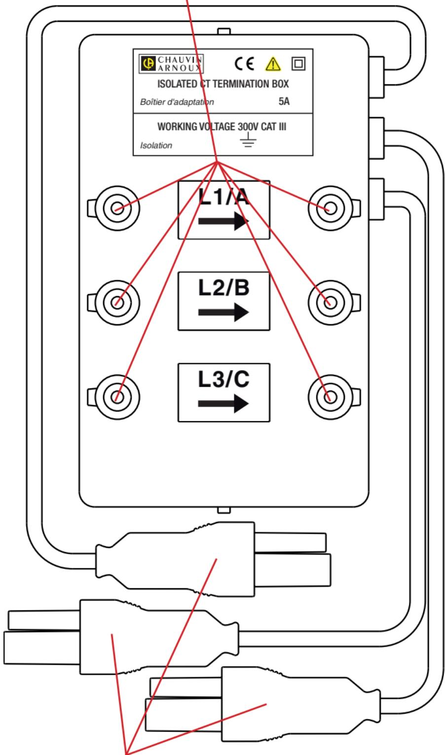
Prises pour connexion à l'analyseur de puissance et d'énergie.
