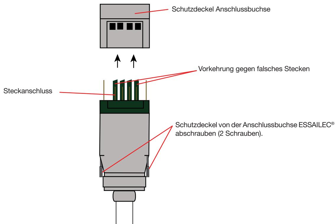
Zum Messen werden die Spannungsstecker an die Strombuchsen des Leistungs- und Energieanalysators angeschlossen. Der Analysator erkennt den ESSAILEC® Baustein automatisch..
