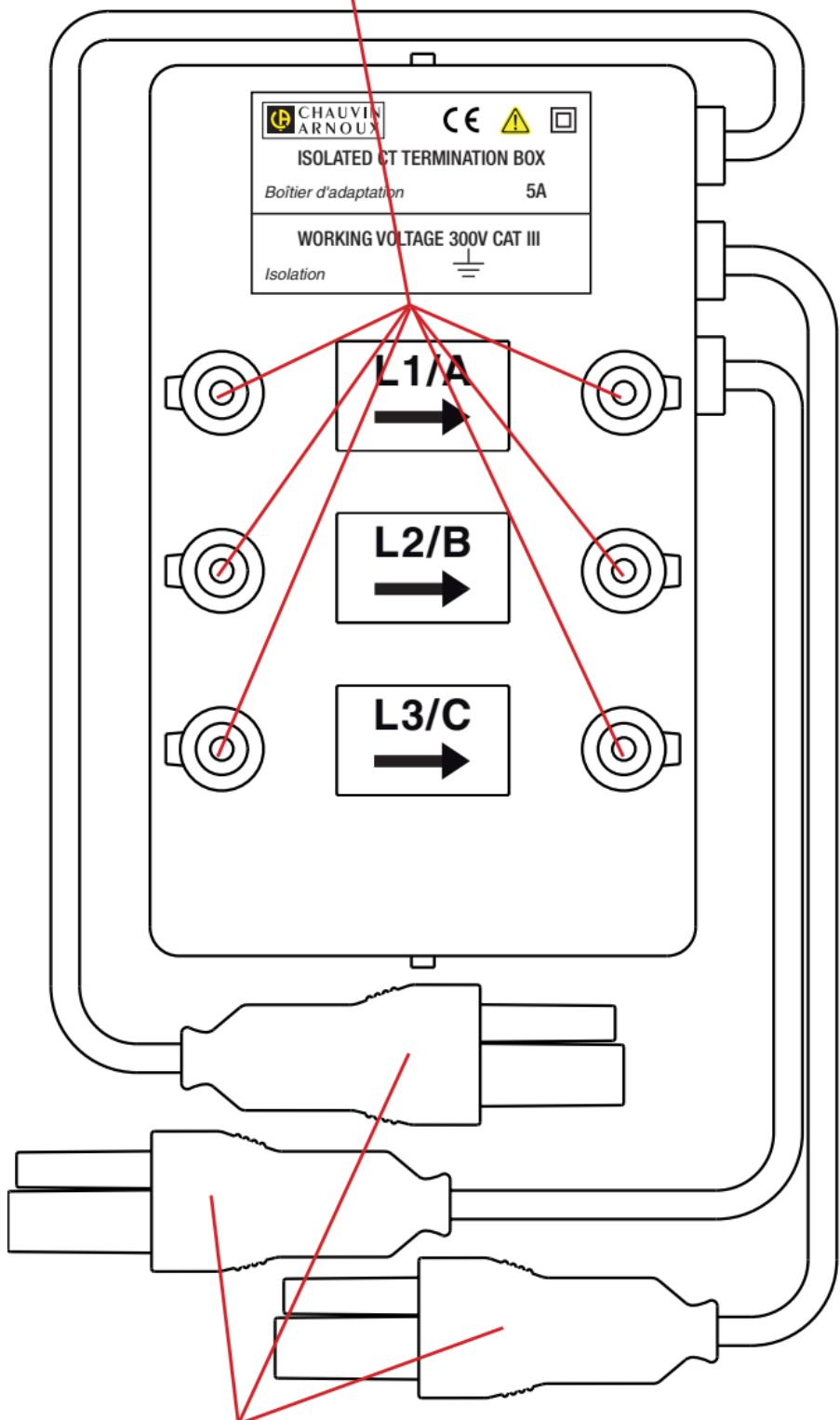
Tomas para conexión al analizador de potencia y energía.
